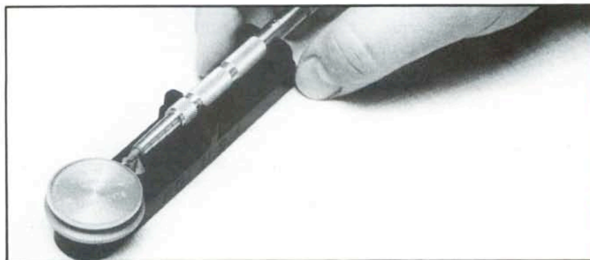
Indicateur utilisé pour vérifier la position de la lame diamant indiquée par le micromètre.
